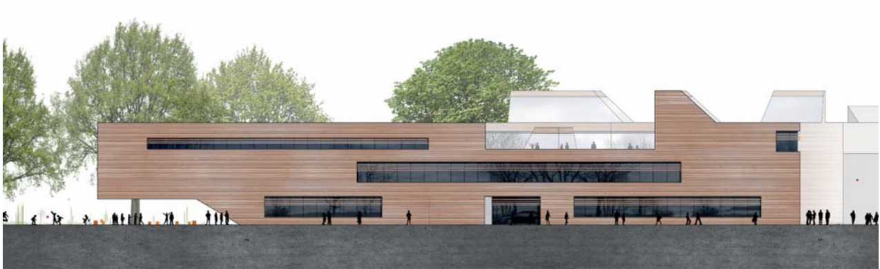
Ansicht Süd: Lärchenholzfassade und Solarkamine
