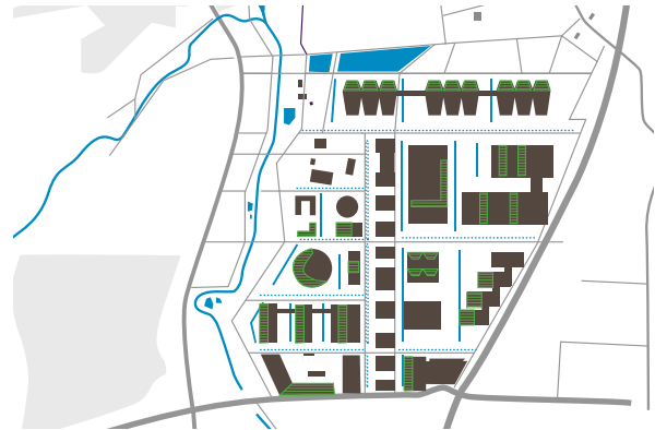
Regenwassermanagement: Gründächer, Mulden, Pflanzenkläranlage
